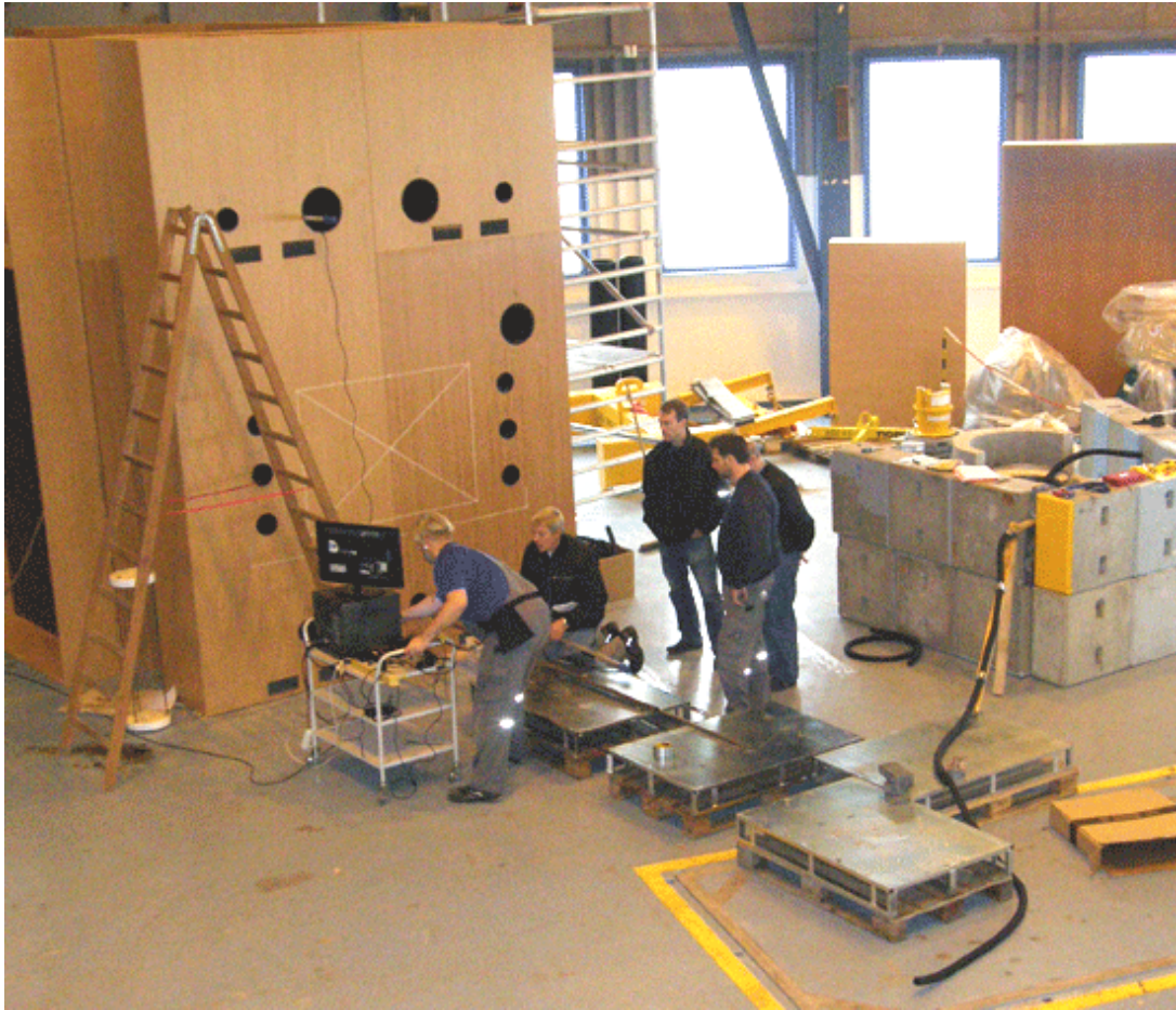
I den gamle DR 2 hal er opført en 1:1 kopi af en af Hot Cell-anlæggets celler, hvor en procedure afprøves og indøves.
