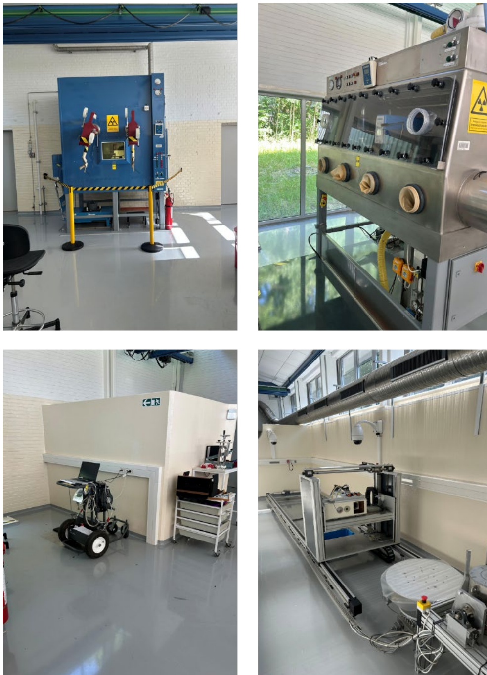
Figur B1.14. Faciliteter i A-lab. Øverst: Hot Cell (venstre) og handskeboks (højre). Nederst: måleopstilling laboratorierummet (venstre) og i målelabyrinten (højre).
