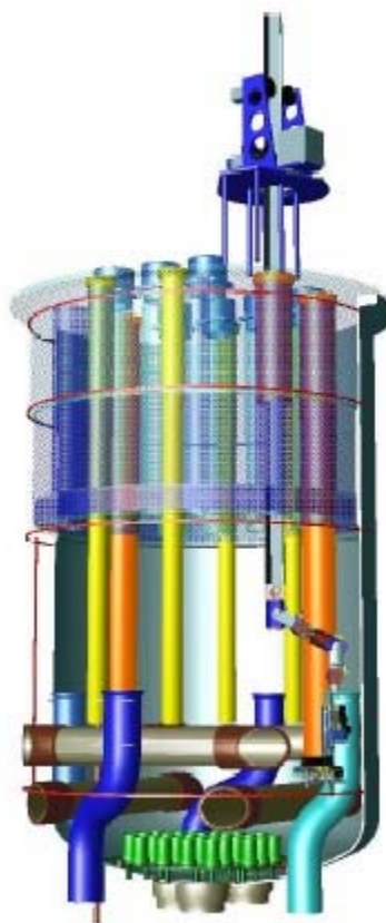
Figur 10.1. Illustration af DR 3's reaktortank med forsøgs- og bestrålingsrør men uden brændselselementer. Det fjernbetjente udstyr til undersøgelse af tankens inderside ses i tegningens højre side.
