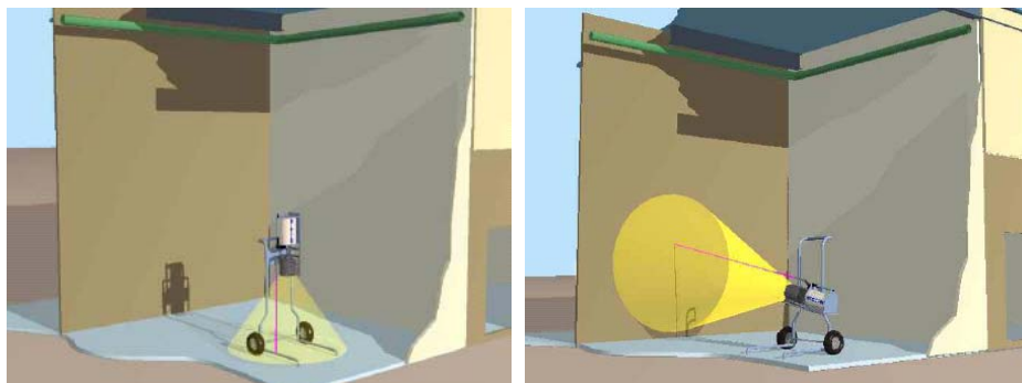
Figur 14. In situ målinger af overflader med en germanium-detektor forsynet med kollimator. Detektoren er placeret med hovedaksen tilnærmelsesvis vinkelret på det areal, der måles på.
