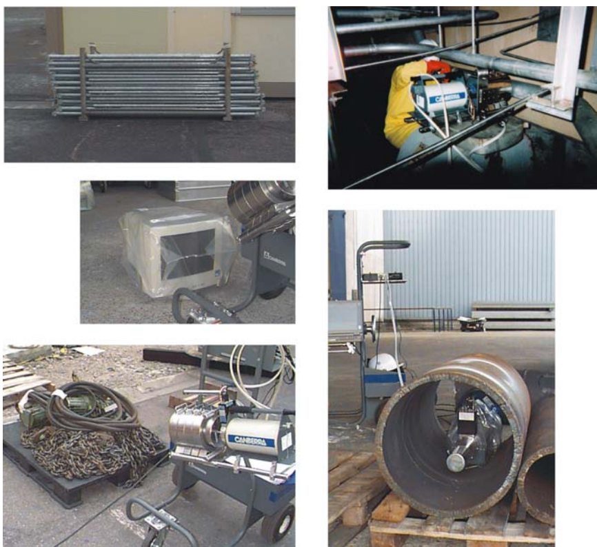
Figur 9. In situ og in toto målinger med en germanium-detektor på emner til frigivelse.
