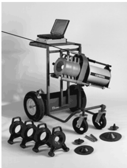
Figur 7. Germanium-detektor med kollimatorer til afskærmning af detektoren. Forskellige åbningsvinkler muliggør målinger på en delmængde af affald og målinger på begrænsede bygnings- eller jordoverflader.
