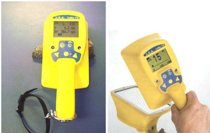
Figur 6. Kontaminationsmonitor Como 170 med ZnS-scintillator der muliggør en samtidig måling af \alpha - og \beta -overfladekontamination.
