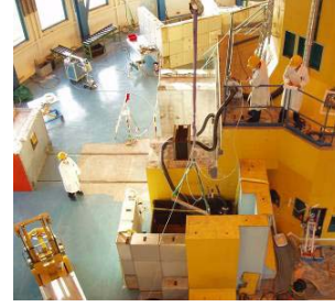
Foto 3 Arrangement for fjernbetjent håndtering af grafit og pakning af container
