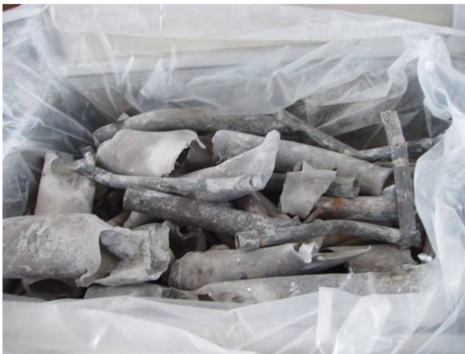
Figur 70 Indstøbte rørstykker fra betonkonstruktionen udtaget til videre kontrol.
