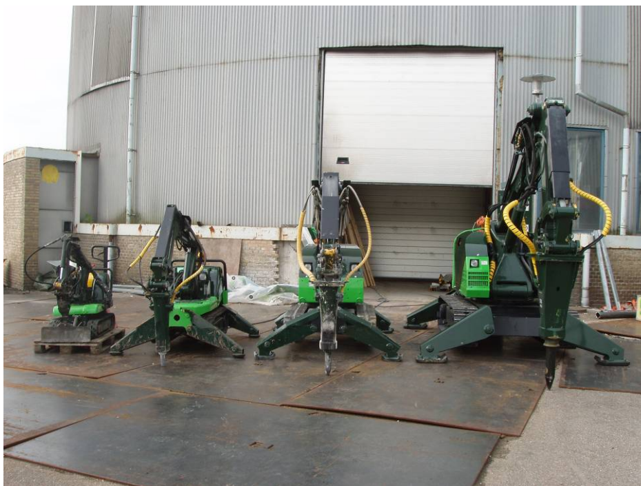
Figur 50 Fjernstyrede nedbrydningsrobotter af typen 'Brokk', som anvendtes på opgaven.
