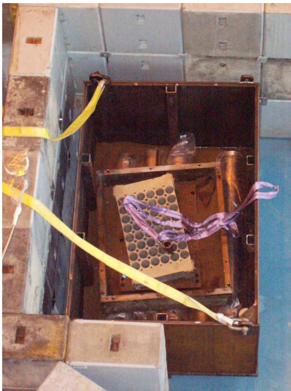
Figur 34 Gitterplade i container før lukning. Afskærmningskassen og plugs kan anes i bunden.
