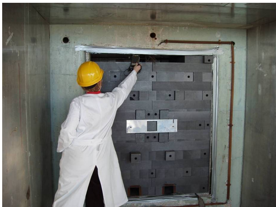
Figur 24 Termisk kolonne med grafit, strålingsniveau måles.
