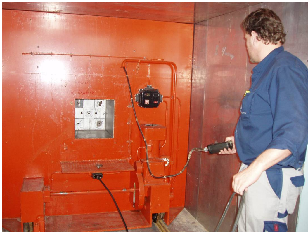
Figur 13 Rulle-døren køres ud. I midten ses plug til udtagning af grafit fra termisk kolonne. Skinnesystemet anes for neden.
