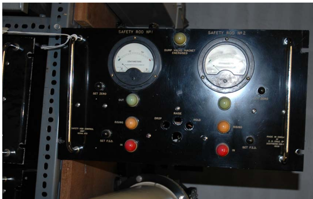
Figur 68. Kontrolenhed til sikkerhedsstænger.
