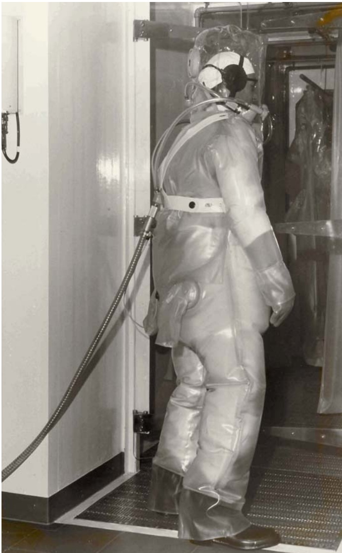
Figur 39. Når der skulle arbejdes inde i Hot Cellerne, var det nødvendigt at benytte en ventileret heldækkende strålebeskyttelsesdragt. En dragt af noget nyere dato vil blive hjemtaget til Steno Museet og den er derfor nærmere beskrevet i afsnit 4.4. Foto fra 1960'erne.
