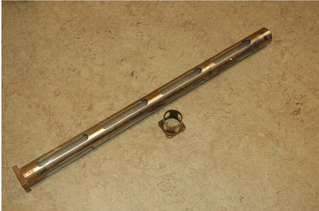
Figur 66. Guidetube eller lederør til sikkerhedsstang
