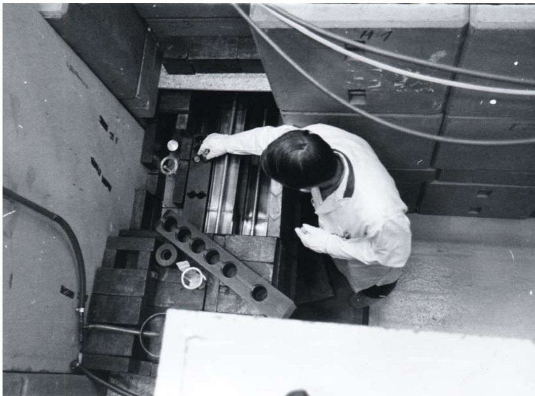
Figur 23. Prøver i bestrålingsdåser er ved at blive anbragt i bestrålingsfaciliteten i den termiske kolonne. Prøverne blev anbragt i huller i dertil indrettede grafitblokke, der med en stang kunne trækkes ind og ud af kolonnen. Foto fra 1960'erne.
