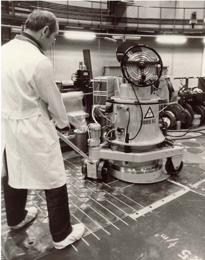
Figur 32. En dåse med silicium flyttes i en blyafskærmet transportflaske til lagerområdet på toppen af DR3 fra det forsøgsrør, hvor den er blevet bestrålet. Si-produktionen er omtalt i teksten nedenfor. Foto fra sidst i 1970'erne.
