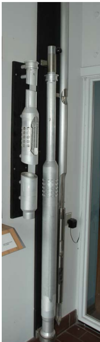
Figur 84. Udstilling, der viser brændselement og forsøgsrør fra DR3.
