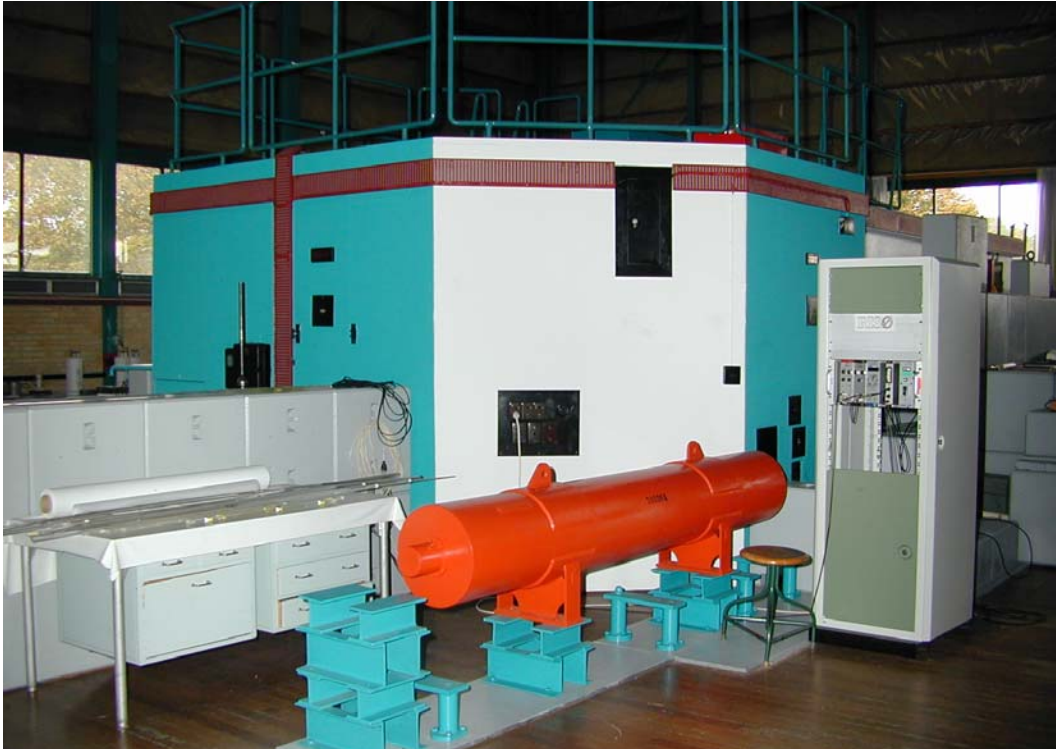
Figur 9. DR1, set fra sydvest 2004. Den aflange røde beholder blev anvendt til opbevaring af emner til bestråling, herunder f.eks. ubrugte brændselselementer til andre reaktorer.
