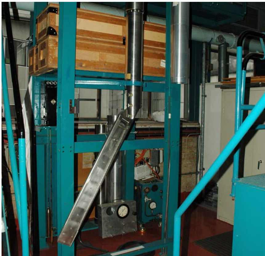
Figur 91. Coarse control arm i position 0 (se omtale i teksten)
