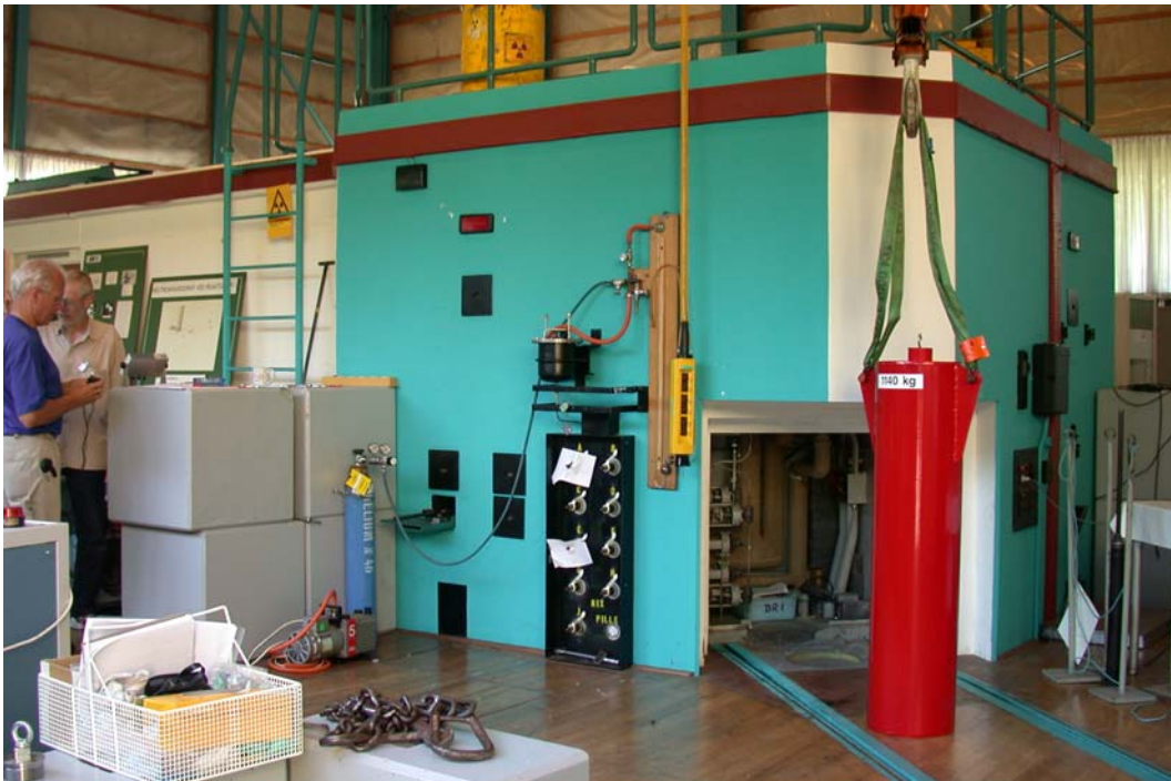
Figur 10. Der gøres klar til den endelige aftapning af uranbrændslet fra kernen, hvilket fandt sted i 16/7 2002. Den røde beholder til brændselsblandingen (13,4 liter) er blyafskærmet og vejer 1140 kg. Foto fra juli 2002.
