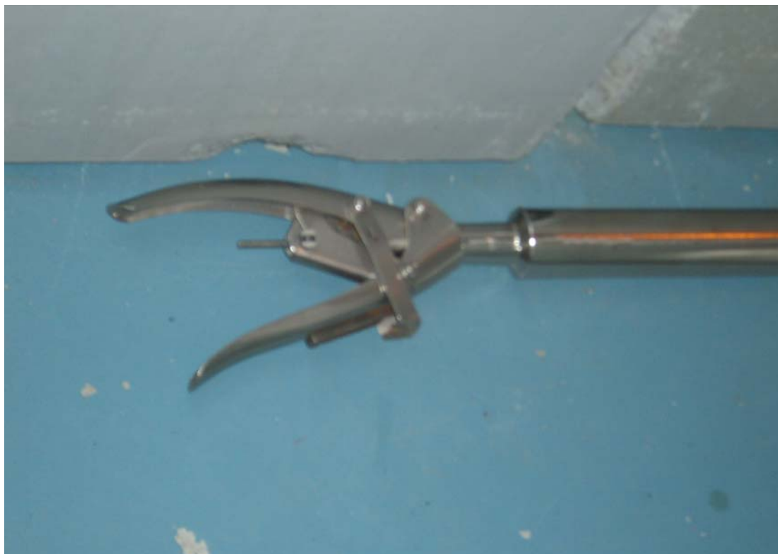
Figur 82. Tang til aktive emner. Billedet viser den ende, hvor fingergrebet sidder.
