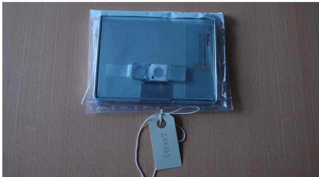
Figur 54. Kasette med røntgenfilm og prøver til neutronradiografi.
