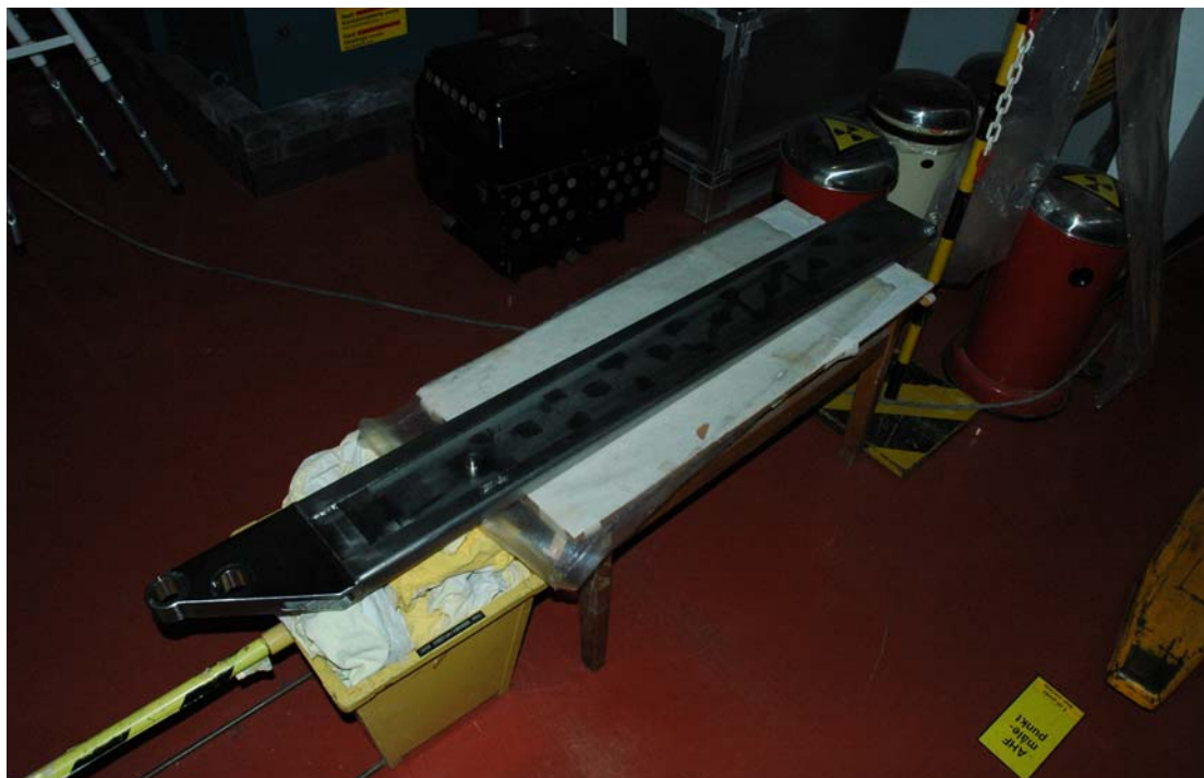
Figur 90. Kontrolblad til coarse control arm fra DR3.
