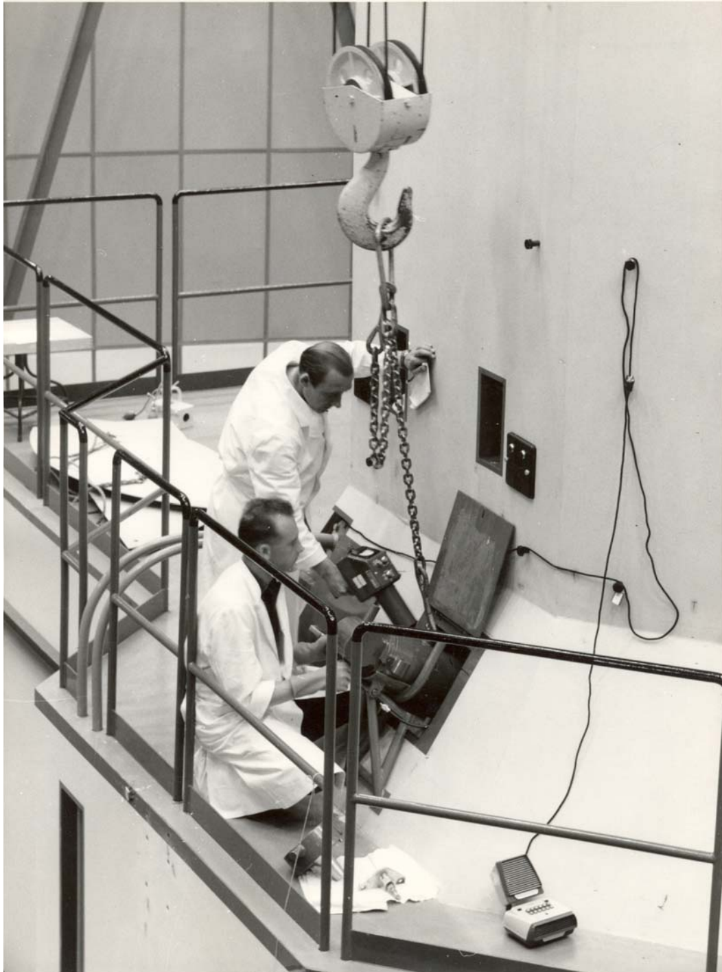
Figur 7. I umiddelbar forlængelse af fig. 6 viser dette billede den sidste del af proceduren for udtagning af prøver fra S-rørene. En ½ time efter endt bestråling var bestrålingsdåsen stadig stærkt radioaktiv, og arbejdet krævede derfor særlige beskyttelsesforanstaltninger. Prøven blev med en wire trukket op i en blycontainer afskærmet med 65 mm. bly, som på billedet er placeret ved forsøgsrørets munding. Containeren, der var så tung, at der skulle bruges en kran til at løfte den, var forsynet med en aftagelig bundprop (ses liggende på balkonen). Den siddende person er ingeniørassistent Poul Horsdal. Hele operationen blev overvåget med en transportabel strålingsmonitor af en (uidentificeret) helsefysiker. Foto fra 1960. Indsætning og udtagning af prøver skete ved handkraft og kunne foregå, mens reaktoren var i drift. Steno Instituttets Billedsamling.
